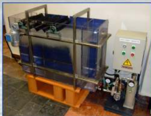
Model testowy flotatora prostokątnego - symulacja napowietrzania pompą NIKUNI
